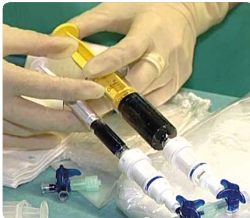
El prototipo consta de diferentes conexiones de jeringas formadas por válvulas estancas.
